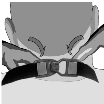
(7) Løsne stroppene ved å trekke i stroppen i låsen med fingeren.
